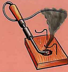
Отсутствие несгораемой подставки под электронагревательным прибором
