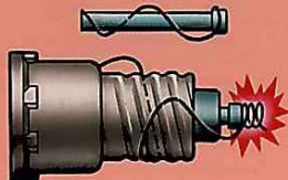
Самодельный пробочный предохранитель ("жучок")
